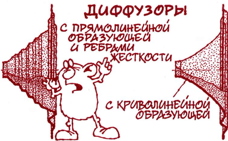
Диффузоры купольных головок изготавливают методом прессования из натуральных и синтетических тканей с последующей пропиткой специальными составами, а также из синтетических пленок и металлической фольги.
